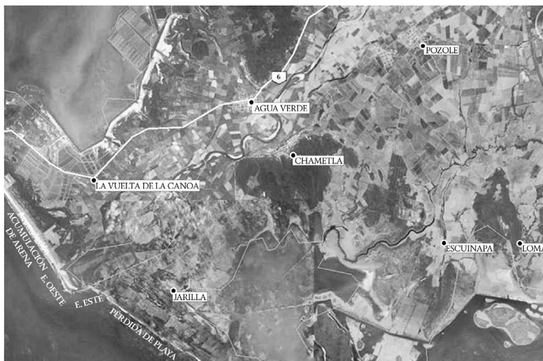
Figura 3. Esquematación de la ubicación de las escolleras y los efectos en la zona costera 3 .
